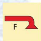
Помещение, защищенное системой пожаротушения пеной ИМО3.16ФС
