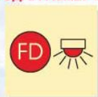
Помещение, защищенное автоматической системой пожарной сигнализацией ИМО3.6ФС
