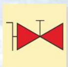
Водяная пожарная магистраль с пожарными клапанами ИМО3.57ФС
