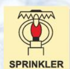
Помещение, защищенное спринклерной системой ИМО3.45ФС
