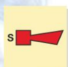
Сирена, предупреждающая о работе спринклерной системы ИМО3.46ФС
