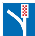
6.5 Полоса для аварийной остановки
