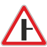
2.3.2 Примыкание второстепенной дороги
