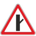
2.3.4 Примыкание второстепенной дороги
